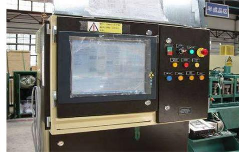
Système de contrôle CAM
